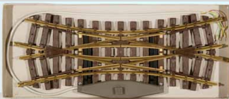
Doppelkreuzungsweiche Nr. 1225 mit motorischem Antrieb. Ein technischer Leckerbissen, – auch wenn sich dieser Antrieb nicht durchgesetzt hat. Die Wetterfestigkeit war nicht gegeben.
