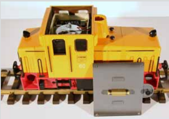
Batteriefach und „Horn“ waren im Führerhaus untergebracht.
